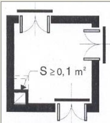
Sistema di sovrappressione ad almeno  $0.3 \text{ mbar}$  anche in condizioni di emergenza.
