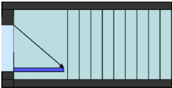
Le porte che danno sulle scale **devono aprirsi sul pianerottolo** senza ridurne la larghezza e **non direttamente sulle rampe**.
