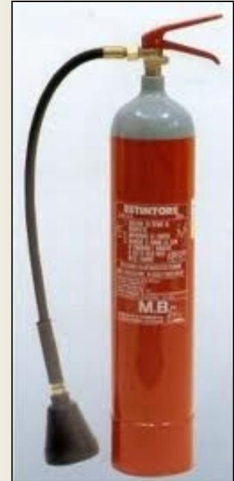
Al momento dell'azionamento la  $CO_2$ , spinta dalla pressione interna **(55/60 bar a 20° C)**, raggiunge il cono diffusore dove, uscendo all'aperto, una parte evapora istantaneamente provocando un brusco abbassamento di temperatura **(-79° C)** tale da solidificare l'altra parte in una massa gelida e leggera sotto forma di piccole particelle denominate "**neve carbonica**" o "**ghiaccio secco**".
