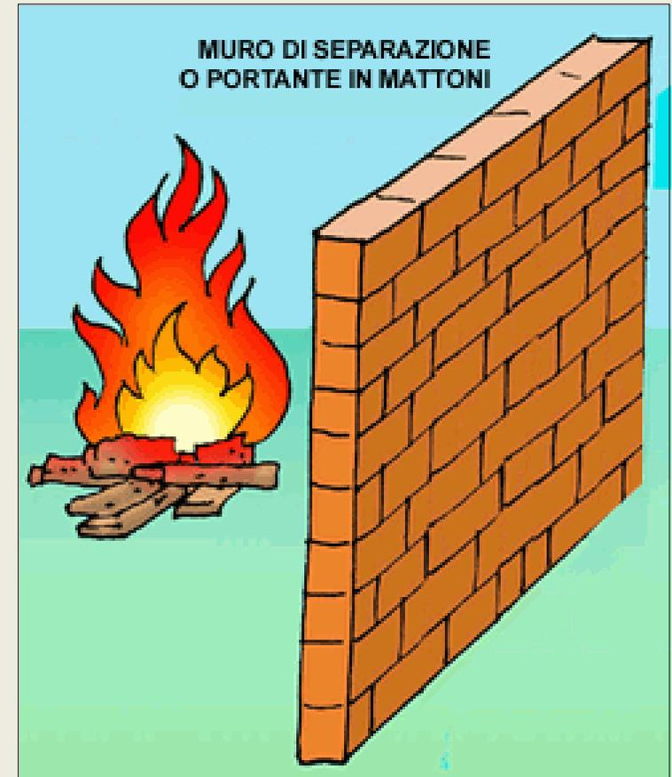
La **resistenza al fuoco** può definirsi come l'attitudine di un elemento da costruzione (componente o struttura) a conservare:
