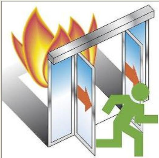
Le **porte di tipo scorrevole** con azionamento automatico sono utilizzabili come uscite di sicurezza, se le stesse possono essere aperte a spinta verso l'esterno (con dispositivo appositamente segnalato) e restare in posizione di apertura in assenza di alimentazione elettrica.
