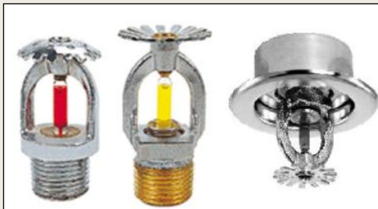
*L'erogazione di acqua può essere comandata da un impianto di rilevazione incendi, oppure essere provocata direttamente dalla apertura delle testine erogatrici: per fusione di un elemento metallico o per rottura, a determinate temperature, di un elemento termosensibile a bulbo che consente in tal modo la fuoriuscita d'acqua.*
