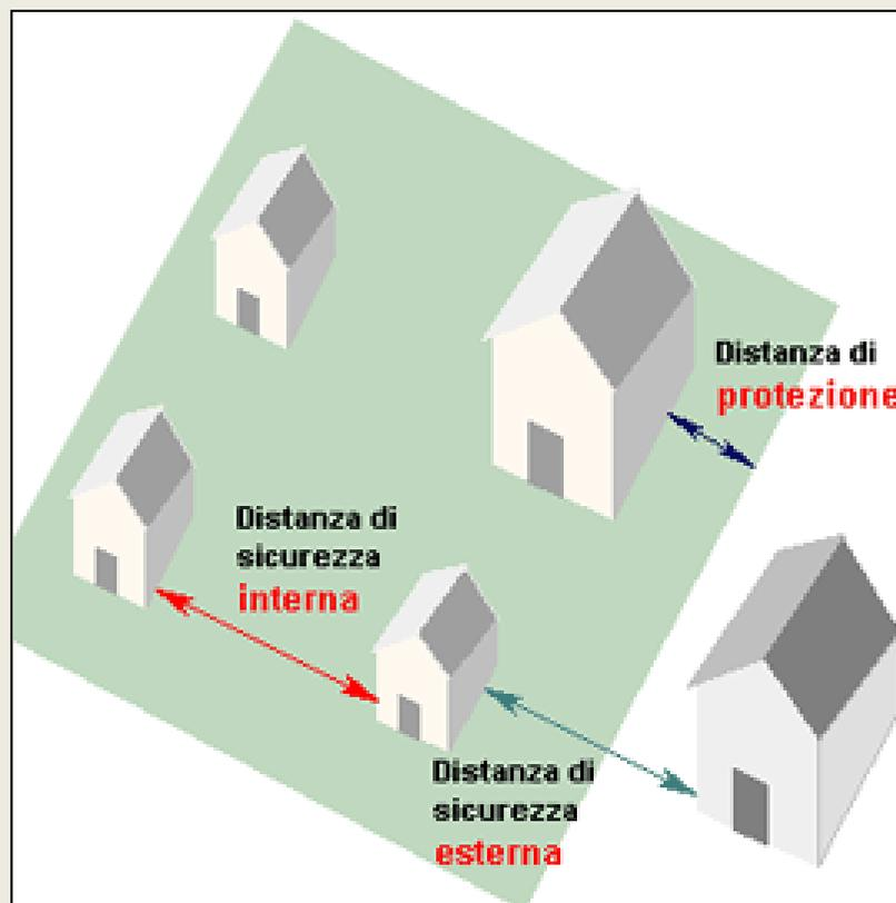
– La determinazione delle distanze di sicurezza si basa sulle determinazioni dell'energia termica irradiata in un incendio, secondo **modelli di calcolo** che forniscono **dati molto orientativi**.
